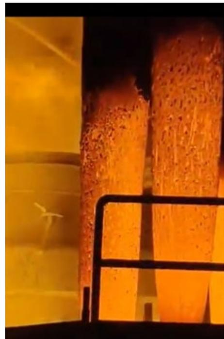
Bild 2 / Seitlicher Abbrand der Elektroden
