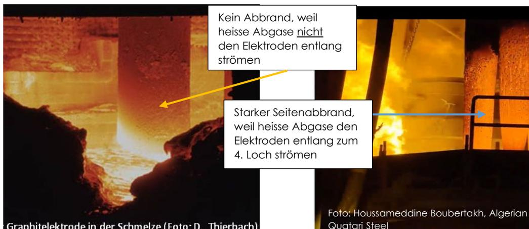
Abbildung 5 / Richtige Ofenluftströmung bedeutet weniger Elektrodenabbrand
